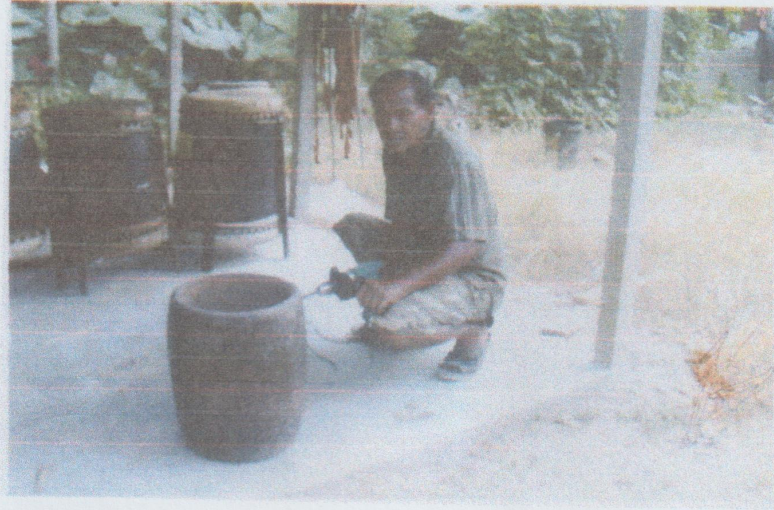
การเจาะรูเพื่อเป็นจุดมัดเชือกชิงหนักรั่ว
